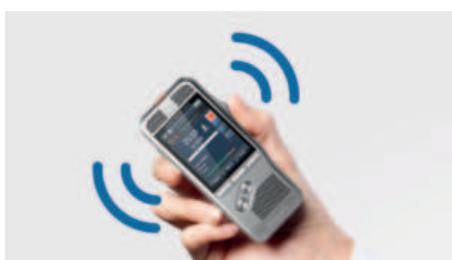
Der integrierte Bewegungssensor erkennt, ob das Gerät auf einem Tisch platziert oder in der Hand gehalten wird und wählt entsprechend das passende Mikrofon für die Aufnahmesituation. Der Bewegungssensor schaltet automatisch auf Standby, wenn das Gerät inaktiv ist. Nehmen Sie das PocketMemo wieder in die Hand, ist es in weniger als einer Sekunde aufnahmefertig.
