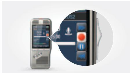
Schiebeschalter-Bedienung (schneller Vorlauf, Aufnahme/Wiedergabe, Stopp, schneller Rücklauf)
