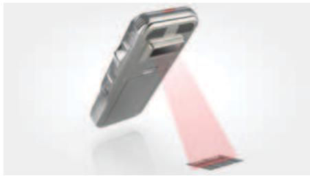
Mit dem integrierten Barcode-Scanner können Kunden- oder Patientendaten durch einfaches Scannen eines Barcodes mit einer aufgenommenen Datei verknüpft werden, sogar von einem Bildschirm.\* Dadurch kann die zuverlässige Zuweisung von Kunden- oder Patienten-IDs sichergestellt und Ihr Workflow beschleunigt werden.
