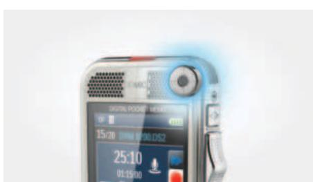
Bei der bahnbrechenden 3D-Mikrofontechnik kommen integrierte Mikrofone zum Einsatz, um stets beste Aufnahmeegebnisse zu gewährleisten: ein omnidirektionales Mikrofon mit 360°-Tonaufnahme für die Aufnahme von mehreren Tonquellen, beispielsweise für Tagungen, und ein für die Sprachaufnahme und erstklassige Spracherkennungsergebnisse optimiertes Richtmikrofon.
